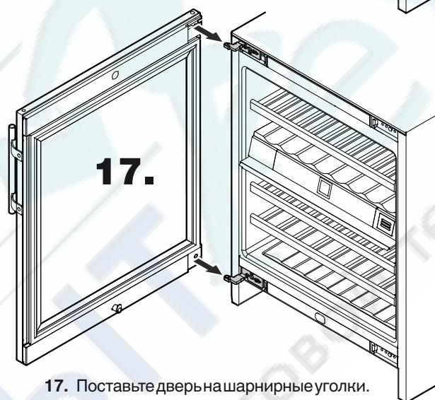
17. Поставьте дверь на шарнирные уголки.
