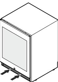
Входящий в комплект поставки пылеулавливающий фильтр предотвращает загрязнение моторного отделения и снижение холодильной мощности. Поэтому установка пылеулавливающего фильтра совершенно необходима.
