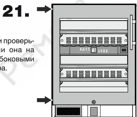
**21.** Закройте дверь и проверьте, находится ли она на одной линии с боковыми стенками прибора.
